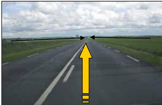
*L'absence d'indices du carrefour sur la voie principale fait que ce dernier est totalement occulté dans le champ de vision du conducteur par la ligne de fuite offerte par le tracé très rectiligne (engendrant des prises de vitesse importante) et renforcée par la possibilité de dépasser. Déficit de lisibilité du carrefour en approche.*
