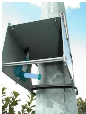
*Un tube passif sur un site de mesures*
