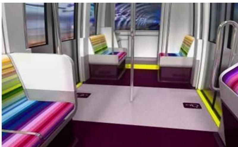
*Un exemple de réalisation dans le cadre de l'opération de rénovation à mi-vie des rames de métro Val 206 : confort et sécurisation avec meilleur éclairage, zone de positionnement des personnes en fauteuil roulant signalé au sol, seuil de porte contrasté*
