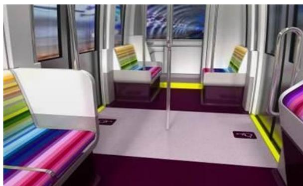
*Un exemple de réalisation dans le cadre de l'opération de rénovation à mi-vie des rames de métro Val 206 : Confort et sécurisation avec meilleur éclairage, zone de positionnement des personnes en fauteuil roulant signalée au sol, seuil de porte contrasté*
