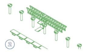
2. Grâce à un engin de chantier spécifique appelé poutre de lancement, les différents morceaux du viaduc, appelés voussoirs, sont installés progressivement.
