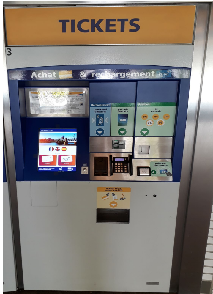
Distributeur de ticket avec aide vocale et hauteur d'écran adapté.
